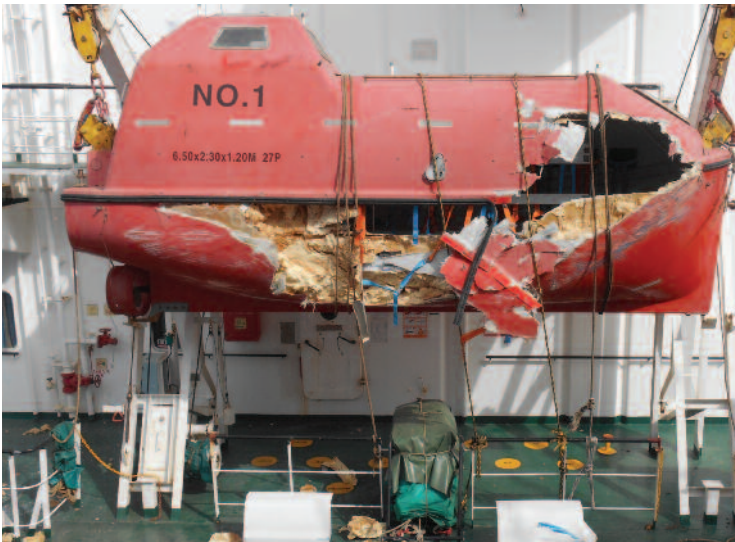
图中船舶的救生艇被另一艘操纵系靠的油轮的左侧首舷碰撞，遭受严重损坏
