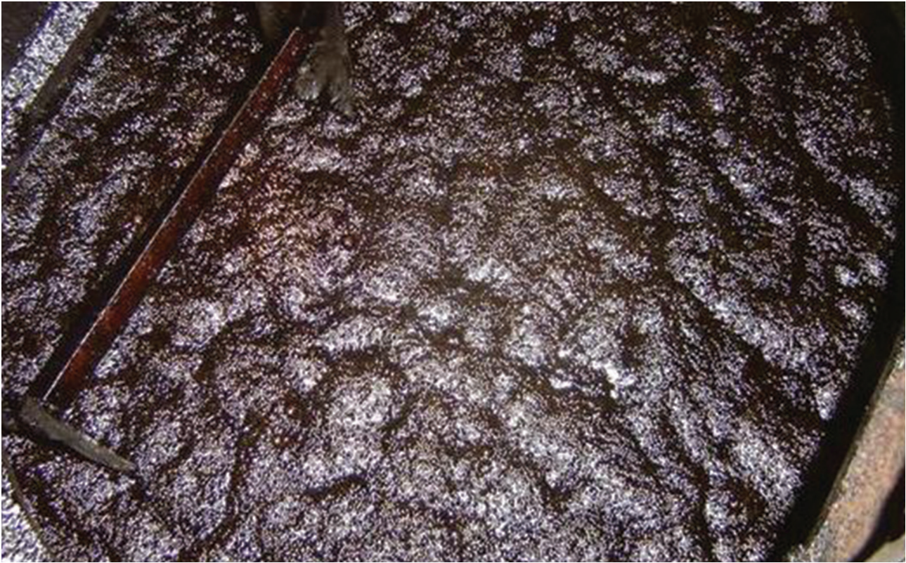
Dầu trong két đáy đôi cho thấy bọt khí nổi trên mặt - hiệu ứng cappuccino
